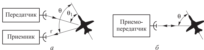
Рис. 2.1. Возбуждение и прием вторичного излучения:
